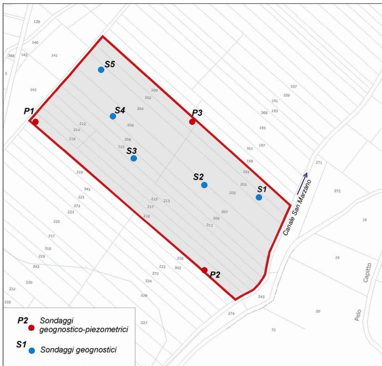
**Figura 3:** Ubicazione dei pozzetti geognostici e dei sondaggi piezometrici.
