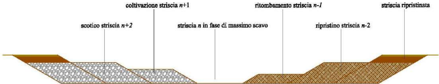
Figura 3.1/1 – Schema di avanzamento della coltivazione e del ripristino per strisce parallele
