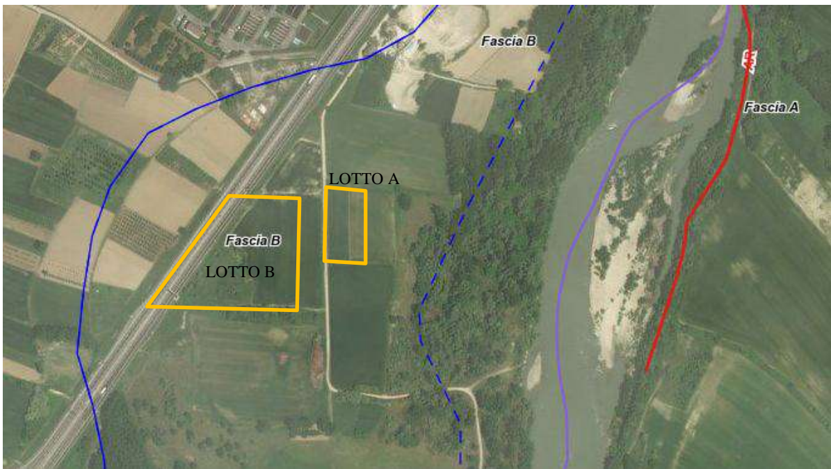
Figura 2.1-2– Foto aerea tratta dal Geoportale AIPO con indicazione delle Fasce Fluviali. Da tale documento si evince con maggiore chiarezza che l'area di cava rientra all'interno della fascia B del P.S.F.F.
