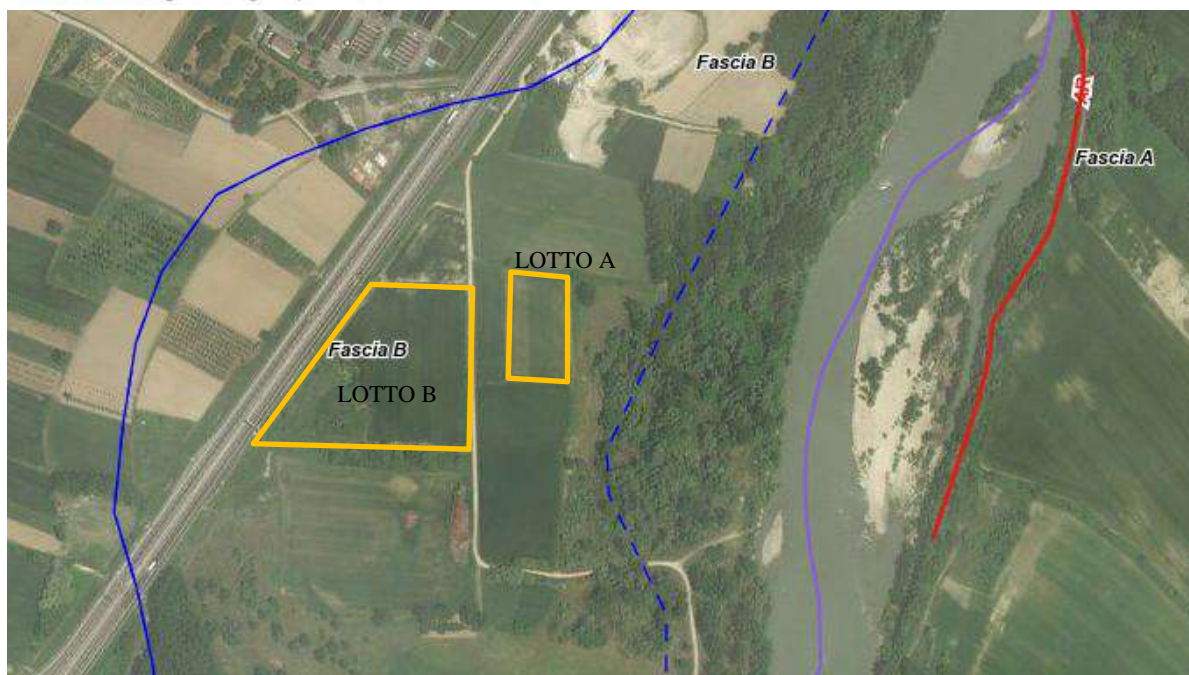
Figura 2-5– Foto aerea tratta dal Geoportale AIPO con indicazione delle Fasce Fluviali. Da tale documento si evince con maggiore chiarezza che l’area di cava rientra all’interno della fascia B del P.S.F.F.
