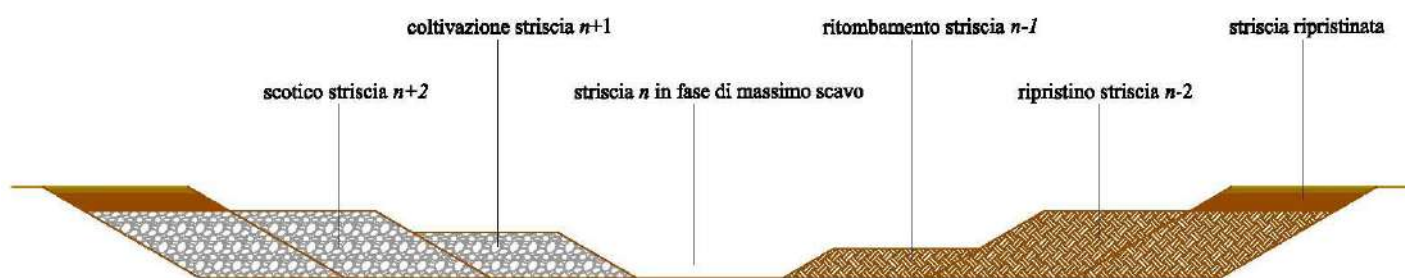
Figura 3-1 – Schema di avanzamento della coltivazione e del ripristino per strisce parallele
