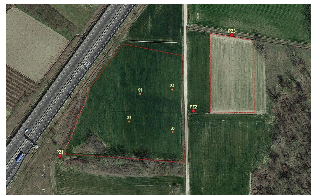
Figura 11: ubicazione dei sondaggi e pozzetti eseguiti
